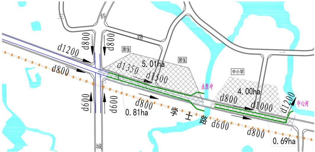
图 2.4 道路雨水方案图
